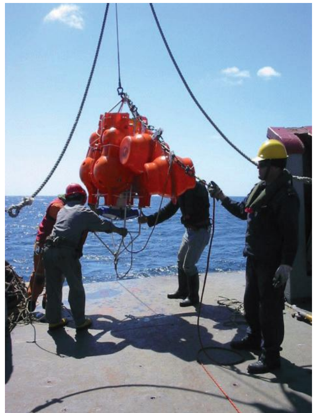
Figura 7.2. Correntómetro Acústico ADCP. Izquierda: ADCP de la compañía Teledyne RD Instruments . Derecha: Instalación de un correntómetro acústico ADCP en un anclaje a bordo de un buque oceanográfico. Se usan boyas o flotadores para mantener el equipo en el fondo lo más vertical posible y así obtener mejores registros de corrientes. Fuente: Cortesía oceanógrafo Raúl Montoya Sánchez.
